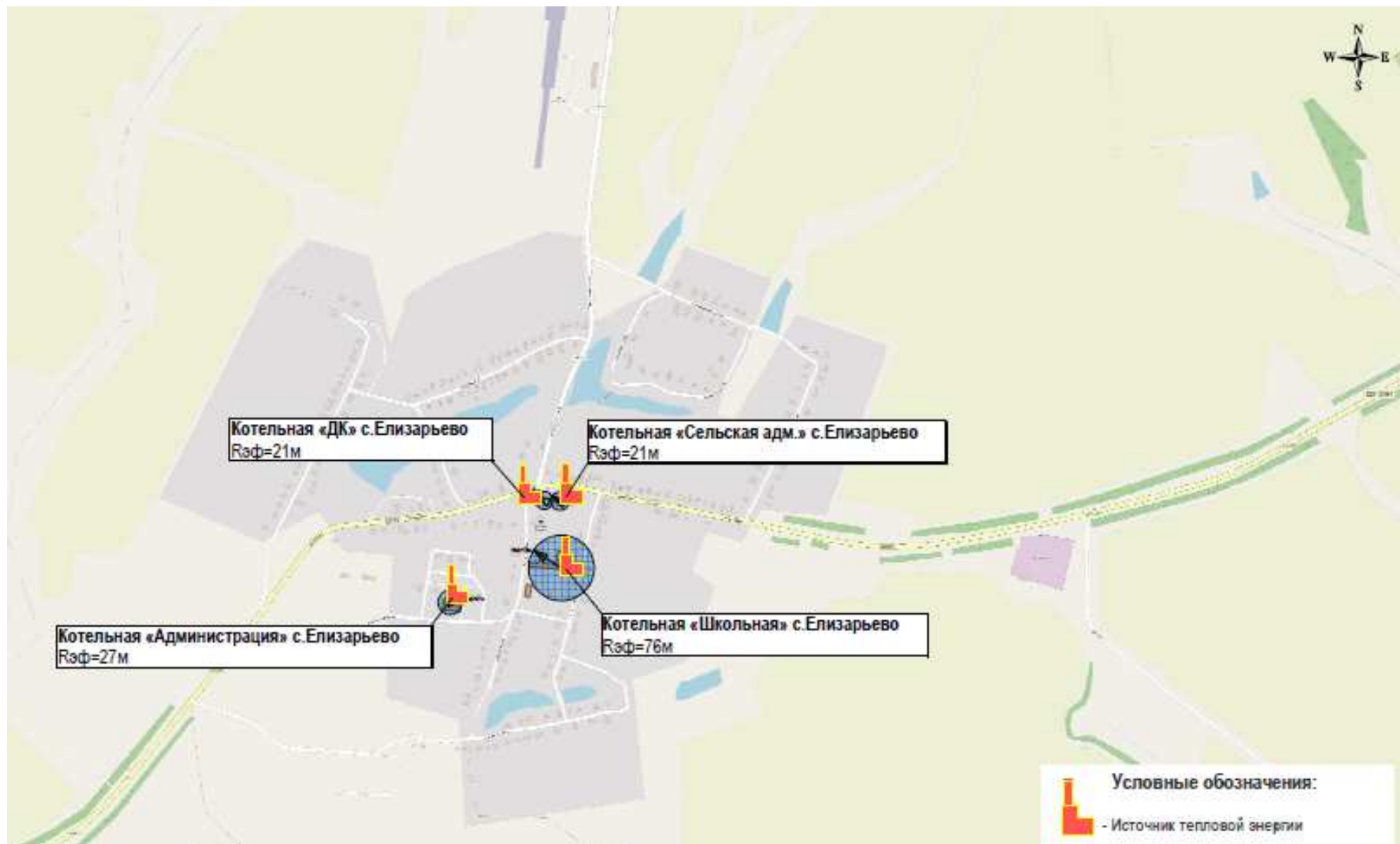
Рис. 2.14. Схема существующих радиусов эффективного теплоснабжения от котельной «Школьная» с. Елизарьево, котельной «Администрация» с. Елизарьево, котельной «ДК» с. Елизарьево и котельной «Сельская адм.» с. Елизарьево.
